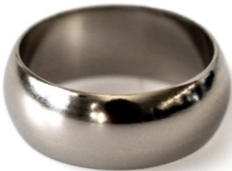
Figura 35 Anello massiccio della lega (2) appena stampato dopo lucidatura.
