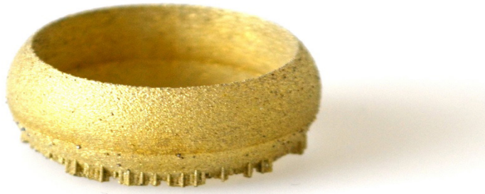
Figura 59 Anello massiccio (B) stampato con lega (3).
