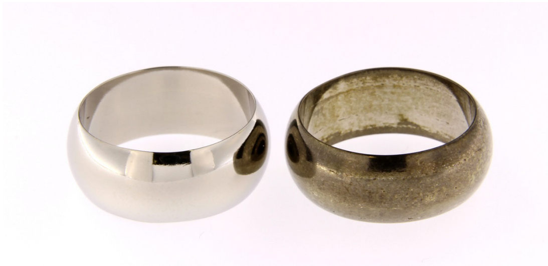
Figura 61 Anello (B) prima e dopo il trattamento di anodizzazione industriale.
