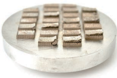
Figura 3 Esempio di campioni con sollevamento delle estremità e distacco dei supporti.
