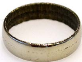
Figura 21 Anello cavo in lega vetrosa dopo la lucidatura.
