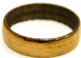
Figura 22 Anello cavo in lega vetrosa dopo la prova in sudore artificiale.
