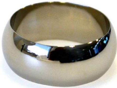
Figura 60 Anello massiccio della lega (3) appena stampato dopo lucidatura.
