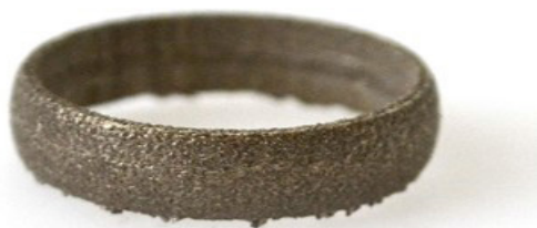
Figura 18 Anello cavo dopo la stampa laser.
