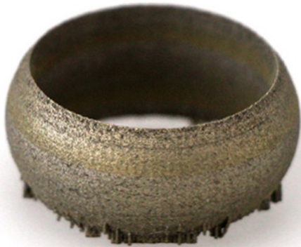
Figura 34 Anello massiccio stampato con lega (2) e potenza di 37.5 W (A).
