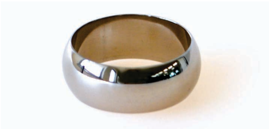
Figura 36 Anello massiccio della lega (2) dopo solubilizzazione e lucidatura.
