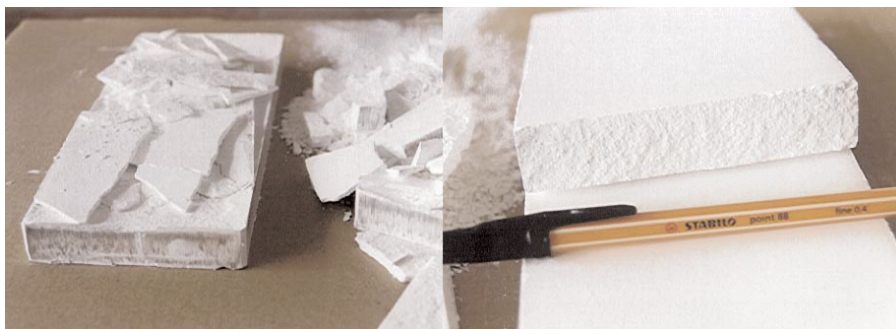
Figura 9 - Campione di Al 2 O 3 pressato senza (sinistra) e con (destra) applicazione del vuoto (Kaiser, 2007) [10]
