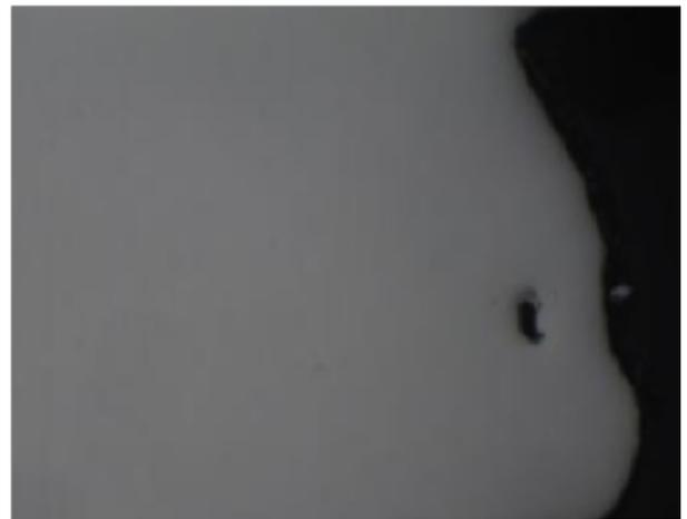
Figura 12b Poro da gas Pt90Ir10 sezionato post-processo HIP
