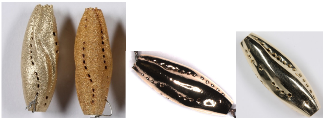
Figura 20: Campioni di gioielli in oro giallo standard nelle diverse fasi di lucidatura. Da sinistra a destra: come prodotto, sabbiato, elettrolucidato, lucidato a mano
