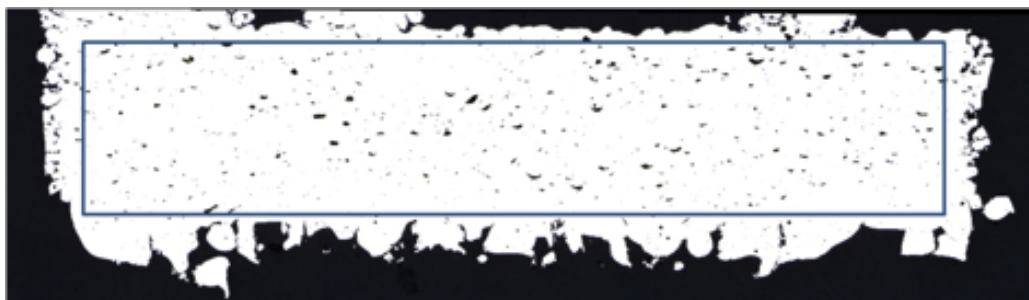
Figura 7: Area rettangolare per la definizione della porosità con microscopio ottico e analisi delle immagini
