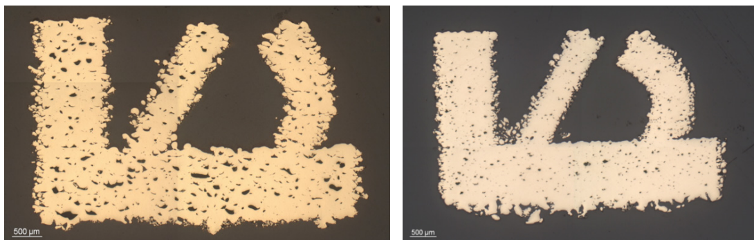
Figura 10: campioni di oro giallo 18k con due set di temperature. Sinistra: v = 50\text{mm/s} , distanza di tratteraggio 27\mu\text{m} , porosità risultante 7%. Destra: v = 250\text{mm/s} , distanza di tratteraggio 36\mu\text{m} , porosità risultante 3,5%.
