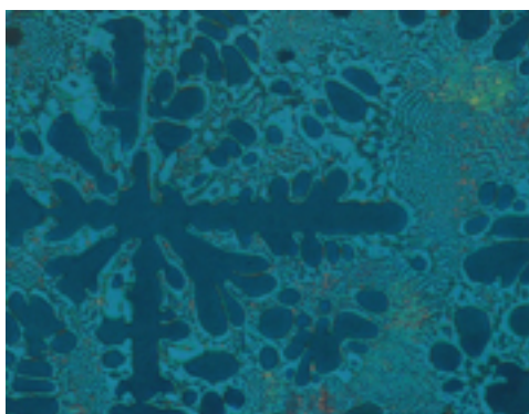
2. Microstruttura di una lega di rame-argento fusa in 2 fasi
