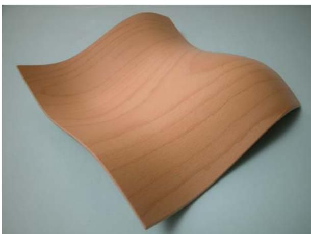
Figura 2 – Legno termoformabile
