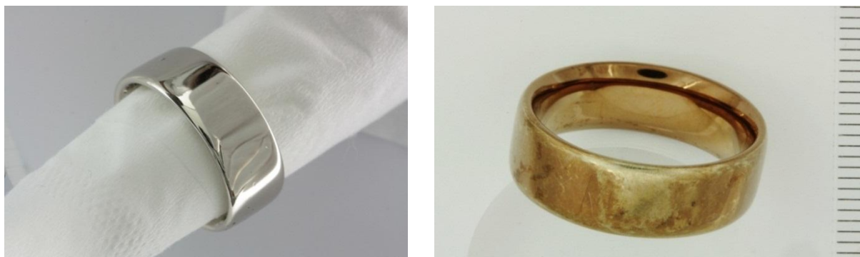
Figura 12: Anello di vetro metallico lucidato (sinistra) e dopo test di indossabilità a 52 giorni (destra)
