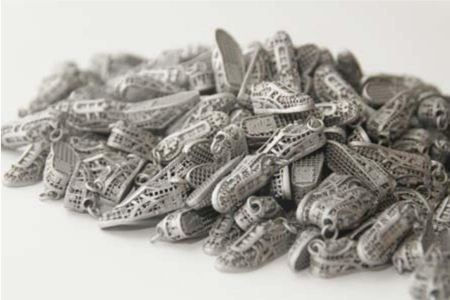
Figura 8 Esempio di accessorio moda di geometria complessa prodotto con la tecnologia FCubic
