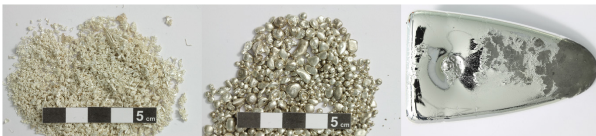
Figura 8 Materia prima 999 Ag per fusione. Sinistra: argento elettrolitico, tenore di ossigeno 400 ppm. Centro: granuli di argento, tenore di ossigeno 250 ppm. Destra: barra di argento fusa sottovuoto, tenore di ossigeno 10 ppm.
