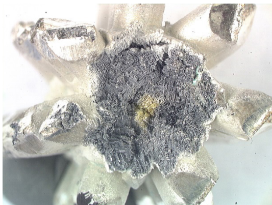
Figura 23 Canale principale di un albero in microfusione di 925 Ag-Cu completamente ossidato in seguito al riutilizzo degli scarti per la colata
