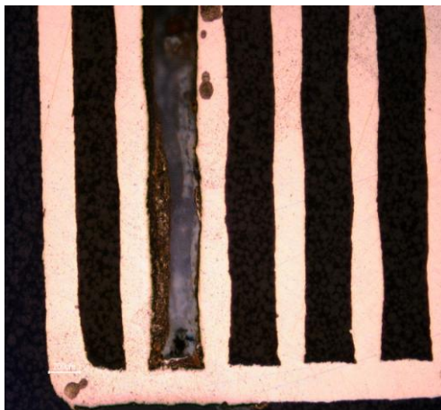
Fig. 15. Vettori con potenza di 72.5 Watt e tempo di esposizione di 80 \mu s.
