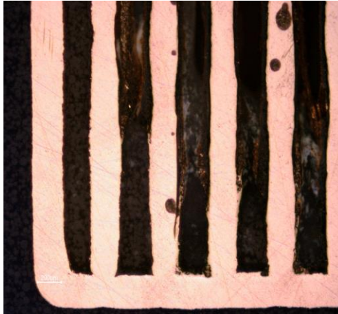
Fig. 13. Vettori con potenza di 92.5 Watt ed tempo di esposizione di 80 \mu s.
