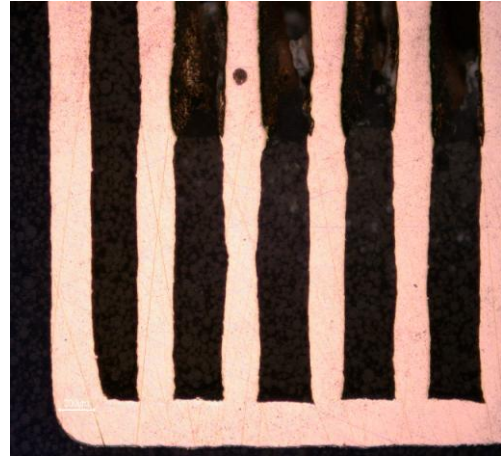
Fig. 14. Vettori con potenza di 82.5 Watt ed tempo di esposizione di 80 \mu s.
