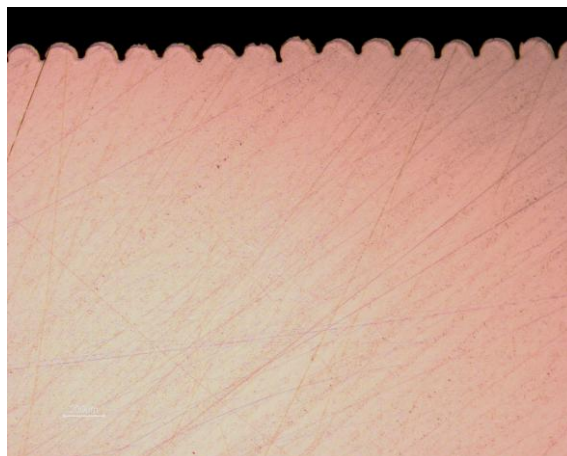
Fig. 41. SLM con polvere di intervallo granulometrico 0–53 \mu\text{m} .
