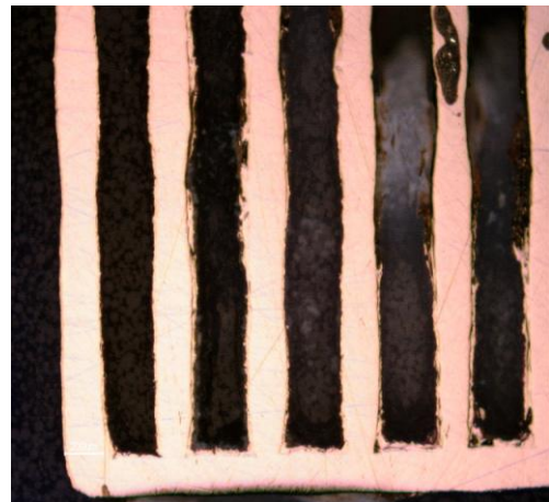
Fig. 10. Vettori con potenza di 82.5 Watt e velocità di scansione di 0.5 m/s.
