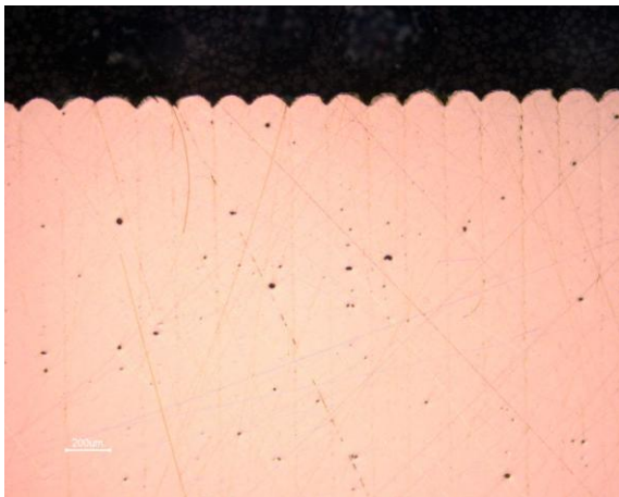
Fig. 21. Sezione trasversale dei vettori con distanza di 180 µm.
