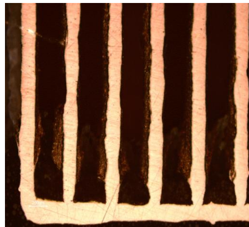
Fig. 16. Vettori con potenza di 62.5 Watt e tempo di esposizione di 80 \mu s.
