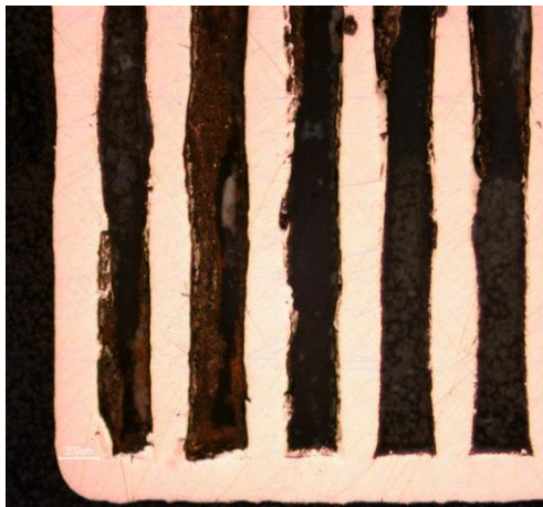
Fig. 9. Vettori con potenza di 92.5 Watt e velocità di scansione di 0.5 m/s.
