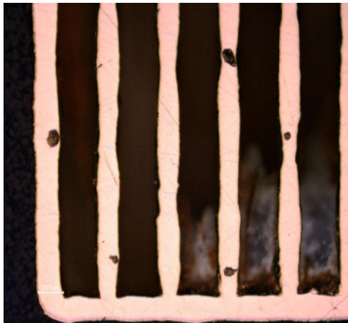
Fig. 11. Vettori con potenza di 72.5 Watt e velocità di scansione di 0.5 m/s.
