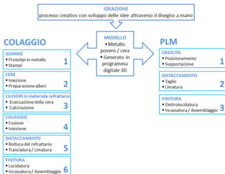
Fig. 1 Schema delle fasi produttive della microfusione o colaggio a confronto con la tecnologia PLM
