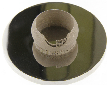
Figura 5. anello in oro bianco con interno cavo realizzato con e senza struttura reticolare di supporto.
