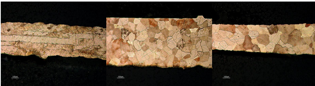
Figura 3. microstruttura di un articolo in lega d'oro giallo, ottenuto con SLM™ (sinistra), con microfusione classica (centro) e microfusione diretta (destra). Nel caso dell'SLM™ la dimensione media rilevata dei grani è di 30 micrometri, in microfusione sull'ordine dei 90 micrometri (5)
