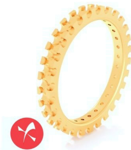
Figura 12. Esempio di anello non adatto alla stampa 3D
