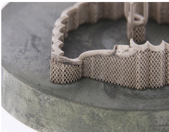
Figura 10. Esempio di rottura dei supporti in un gioiello in oro bianco.
