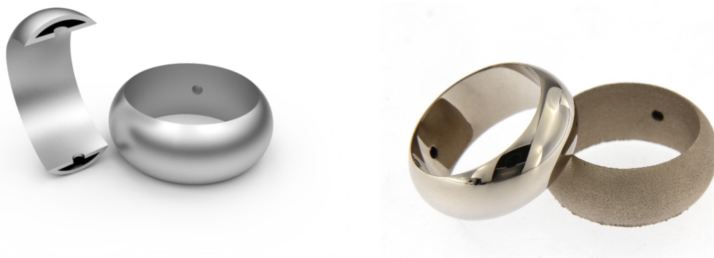
Figura 4. Esempio di fede nuziale cava realizzata tramite SLMTM in oro bianco: modello 3D (sinistra) e oggetto stampato (destra)
