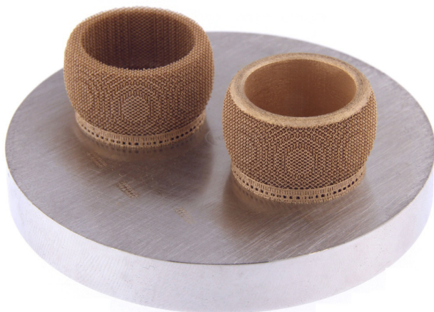
Figura 7. Anelli stampati in oro rosso con struttura reticolare tridimensionale estesa, con e senza parete piena interna.
