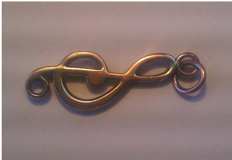
Figura 3 - Portachiavi in bronzo rodiato dopo 4 anni di utilizzo. E' perfettamente visibile la colorazione rossiccia della lega sottostante a seguito della progressiva usura superficiale e rimozione dello strato di rodio superficiale.
